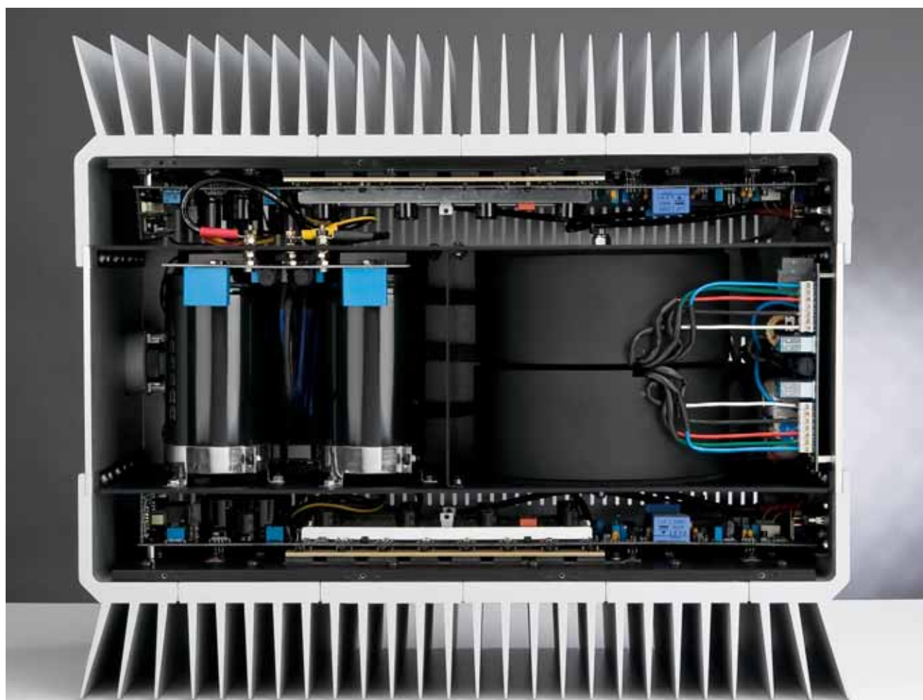
Massimo ordine anche nel mastodontico finale, merito della corretta ingegnerizzazione che ha ripartito lo spazio in tre volumi, ponendo al centro gli ingombranti trasformatori ed i condensatori e relegando l'elettronica al montaggio verticale a ridosso dei radiatori.
