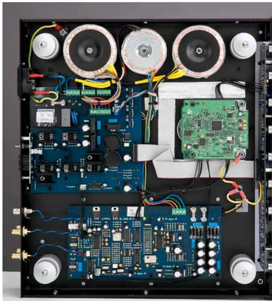
E questa è l'altra faccia del lettore, quella inferiore, dove sono alloggiati i tre trasformatori, uno per ciascun canale ed uno per i servizi, e l'ampia scheda del convertitore D/A con il suo clock di precisione.
