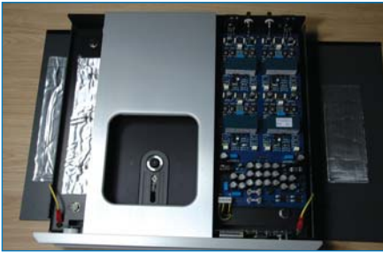
Il CD One aperto mostra la componentistica e la meccanica Philips Pro-2 collocata in posizione centrale.
