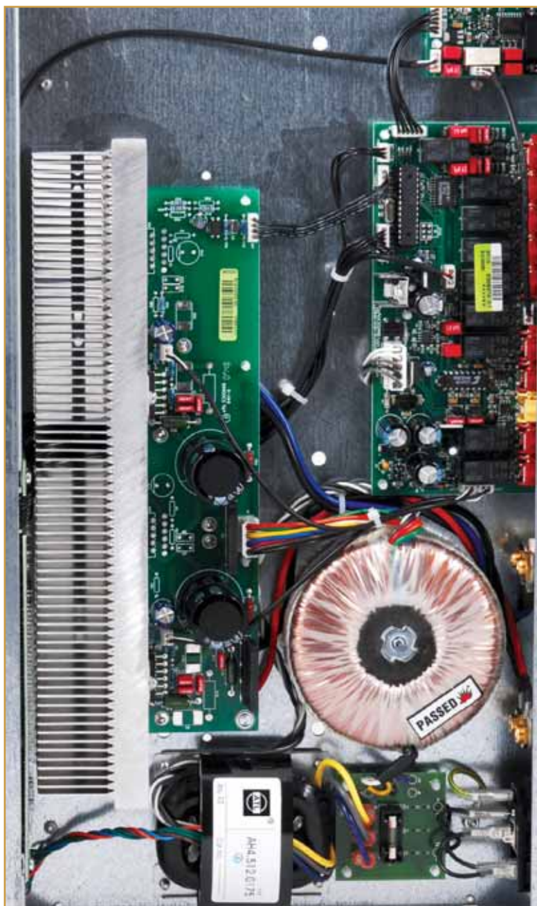
Sezione di alimentazione ben dimensionata, piastra circuitale ordinata e pulita. Il dissipatore dei dispositivi di potenza è posto a ridosso del pannello frontale.
